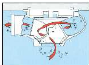
Σχήμα 7: Πτερωτές κατάλληλες για άντληση ανεπεξέργαστων λυμάτων.
