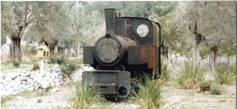
Η ατμάμαξα Decauville της στενής γραμμής (0,60 μ.) Σκύδρας-Αριδαίας, όπως αυτή ανακαλύφτηκε τον Απρίλιο του 1984 στην Ερμιόνη Ν. Αργολίδος, από μέλη του Συλλόγου των Φίλων του Σιδηροδρόμου της Αθήνας (Φωτ. Σ. Παπανδρεάδη)
